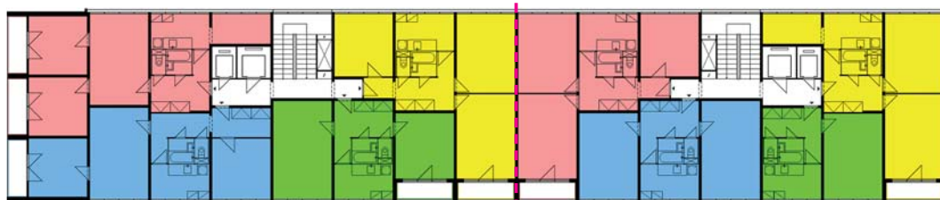
Typické podlaží panelového domu G-OS; vyobrazená varianta představuje přímo prototyp, má proto okna přes celé místnosti. Druhý krajní modul tvoří zrcadlově obrácená část oddělená čarou.
