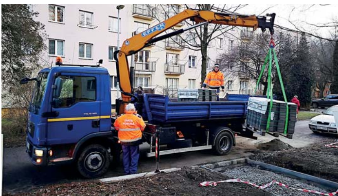
Pracovní četa má od nového roku k dispozici také nákladní auto s hydraulickou rukou. Foto: Martin Otipka
